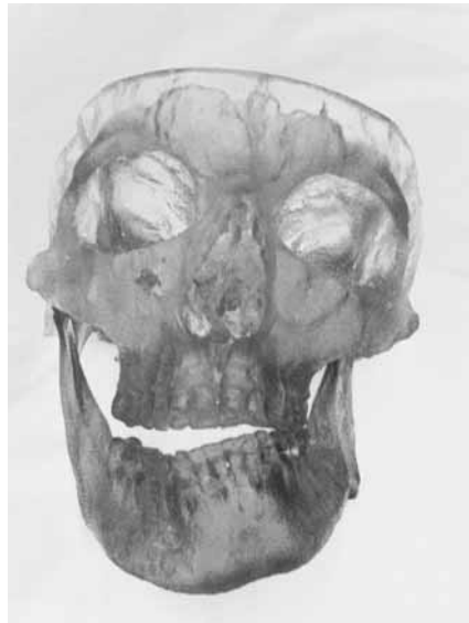
Ryc. 5. Model stereolitograficzny chorego z asymetryczną wadą szczęk i żuchwy, wykonany na podstawie trójwymiarowej tomografii komputerowej.
