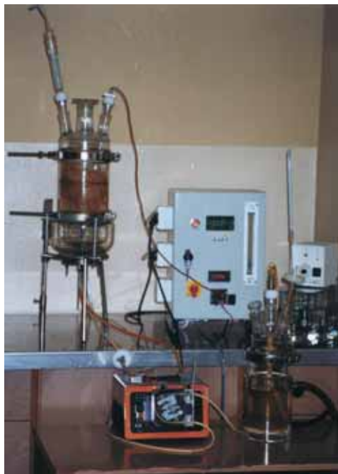
Fot. 1. Układ bioreaktora zasilanego rozpyloną pożywką.
