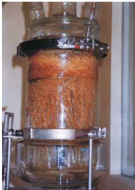
Fot. 2. Kultura korzeni włośnikowatych Paulownia tomentosa w bioreaktorze zasilanym rozpyloną pożywką (o pojemności 5 dm 3 ).
