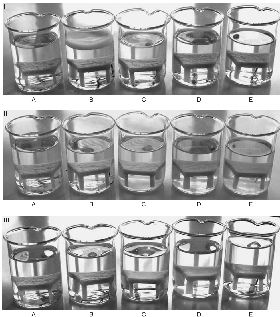
Rys. 2. Enzymatyczne usuwanie biofilmu związanego z płytką akrylową (26). Widok przed (I), po 12-godzinnej hydrolizie (II) i kilkakrotnym płukaniu wodą (III). (A – kontrola bez dodania enzymu, B – preparat handlowy, C – egzomutanaza + dekstranaza, D – endomutanaza + dekstranaza, E – egzomutanaza + endomutanaza + dekstranaza).
