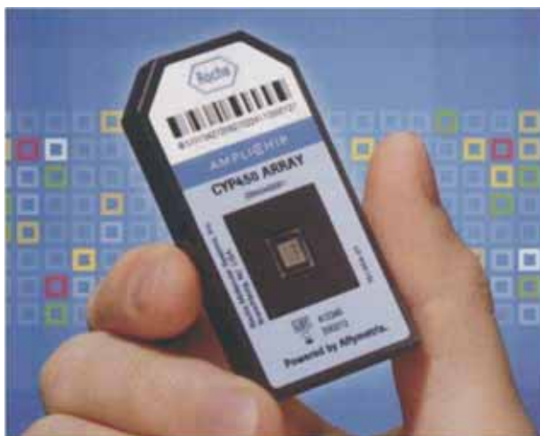
Rys. 5. Przenośne urządzenie diagnostyczne AmpliChip do oznaczania aktywności enzymów z grupy cytochromu P450.
